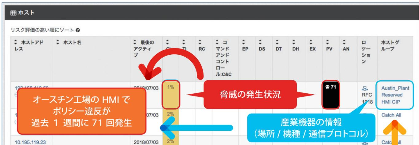
Cisco IND が産業機器の情報をリスト化して Cisco Stealthwatch と共有
